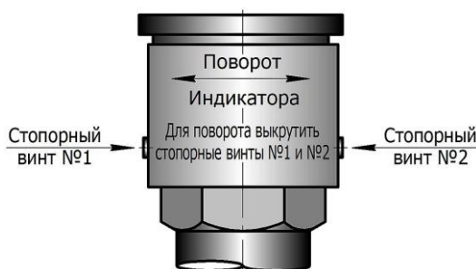
Рисунок 15 – Расположение указателя поворота и фиксирующих винтов «1» и «2» на стойке
