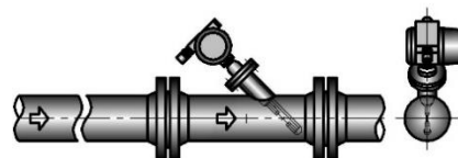
Рисунок 6 – Установка датчика расхода исполнений ФВ , ФВЛ , В и ВЛ ( D_u \geq 200 мм)
