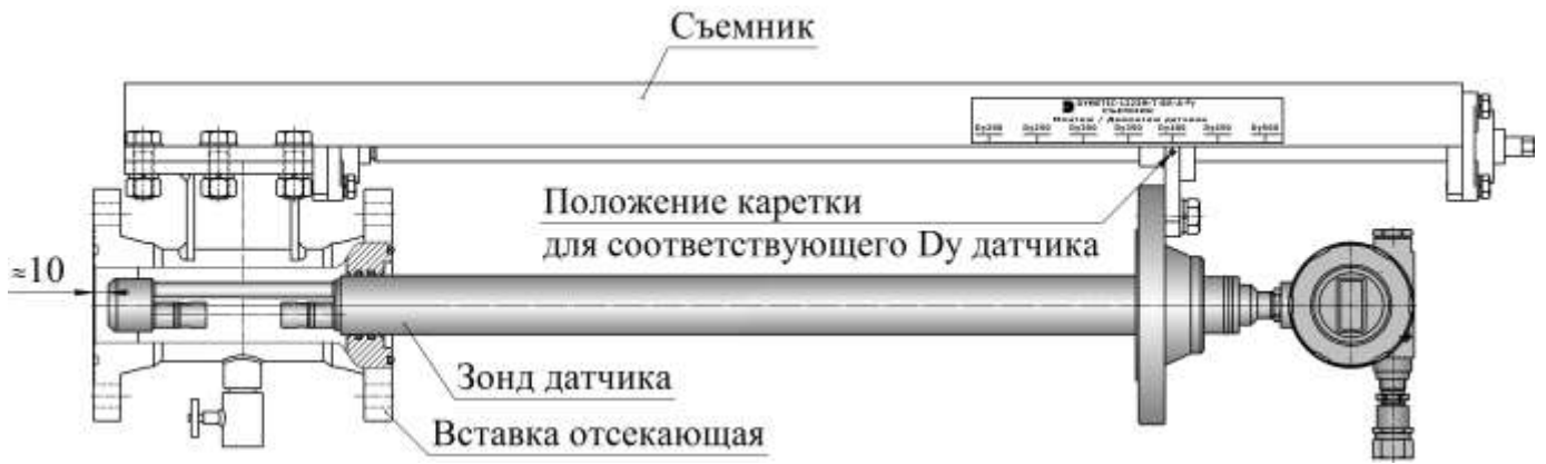
Рисунок 4 – Установка положения зонда датчика расхода
